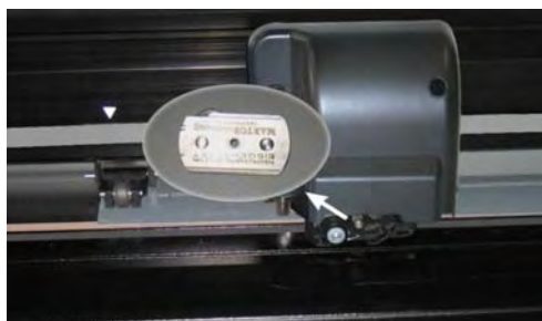
ABB 1-35 RASIERKLINGE FÜR AUTOMATISCHE TRENnung DES WERBETRÄGERS
