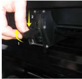
ABB 5-1 HOCHHEBEN DER ANDRUCKROLLE
